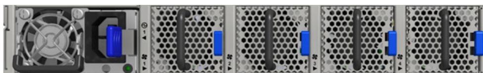
Figure 30: Fan Module Latches
